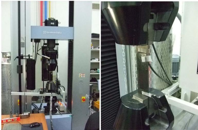
그림 2. 광섬유격자센서 내장 FRP 스트립의 인장 재하시험
